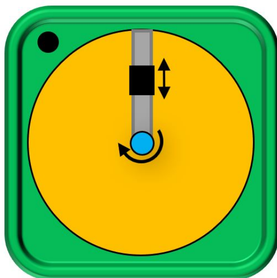
Figur 2.5: Illustrasjon av sylinderrobotarm over klemmekar. Den blå sirkelen indikerer stedet hvor festeordningen er koblet til roboten.
