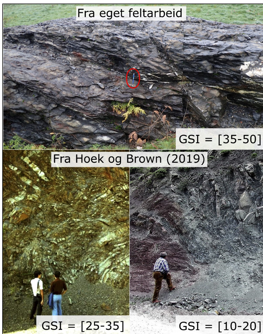
Figur 79: Eksempel på bergmassekvalitet fra eget feltarbeid sammen med eksempler på dårligere bergmasse fra Hoek og Brown (2019). Penn (med rød ring rundt) for skala i bildet øverst og mennesker for skala i bildene nederst.
