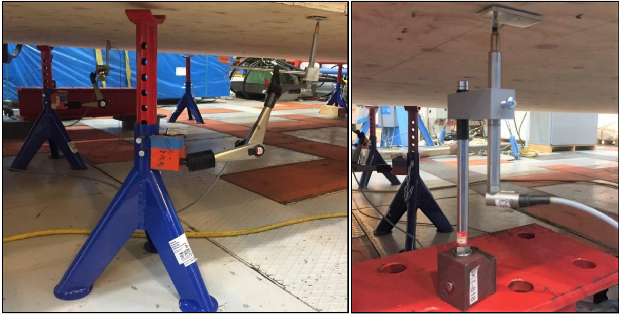
Figur 3-26 Innfesting av nedbøyningssensorer. Til høyre ses den som ble montert på en liggende IPE-bjelke.
