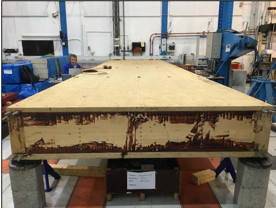
Figur 3-1 Komposittdekket i laboratoriet med opplagerbetingelser. Dette bildet er tatt før ANCO-vibratoren ble montert.
