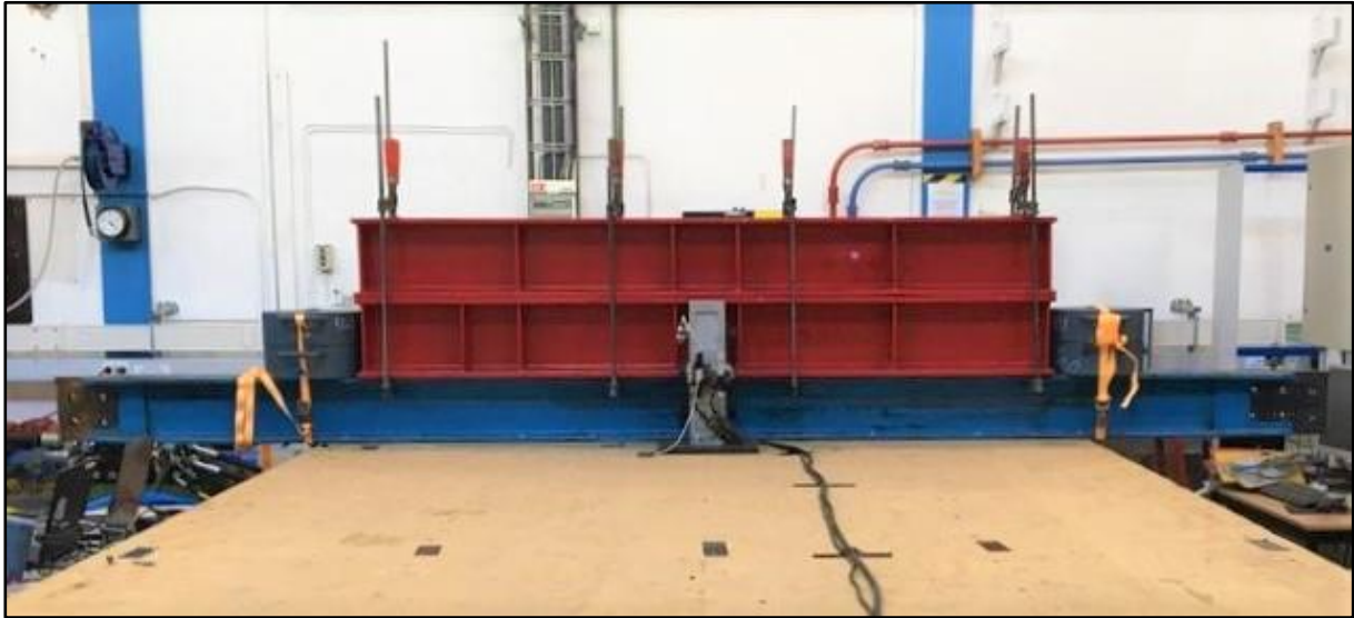
Figur 3-14 Gulvet belastet med massetrinn 4 i laboratoriet. I ytterkant ses de runde loddene, festet med lastestropper.
