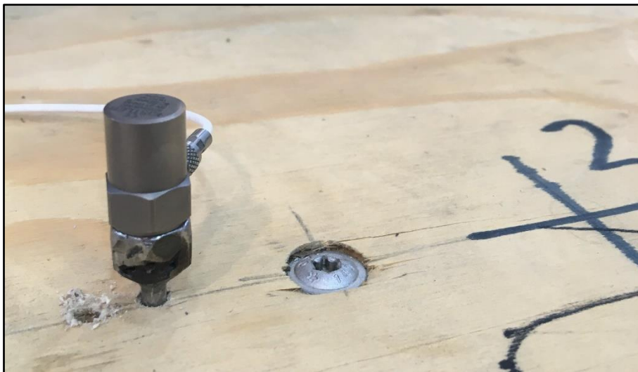
Figur 3-17 Akselerometeret ble festet til dekket med treskrue. Dette akselerometeret er ikke av typen Kistler 8770A50, men prinsippet for innfesting er det samme.
