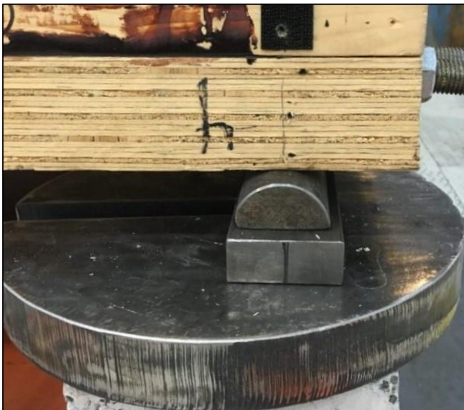
Figur 3-2 Nærbilde av opplegg på stålhemisfære i hjørne.
