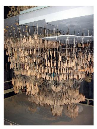
Figure 2.3: Hanging chain model of Colònia Güell [3].
