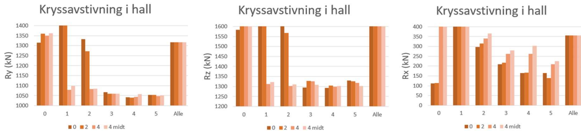
Figur 5.37: Reaksjonskrefter for doble kryss.
