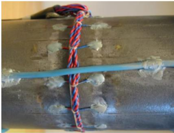
Figur 42: Her ses flere pinnepar på et tidligere laboratorieforsøk om utmatting på et stålrør (39)
