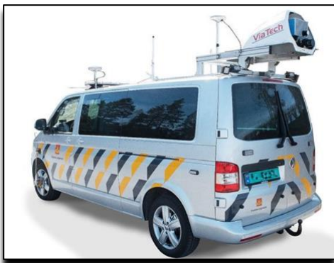
Figur 14. Målebil for spor, ujevnhets og tverrfall. (Via Tech AS)
