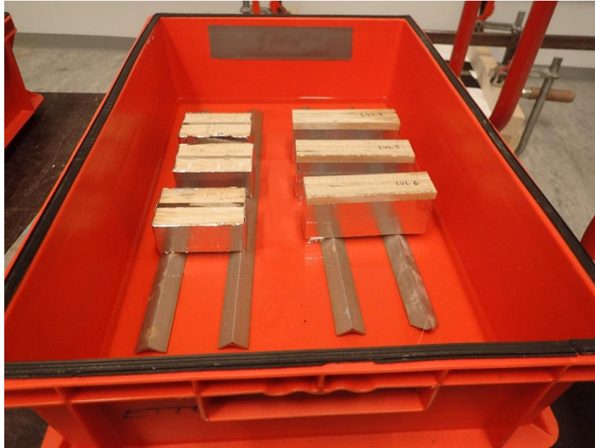
Figur 11: Forsøksoppsettet avbildet underveis i forsøket - karet med LVL-prøvene.
