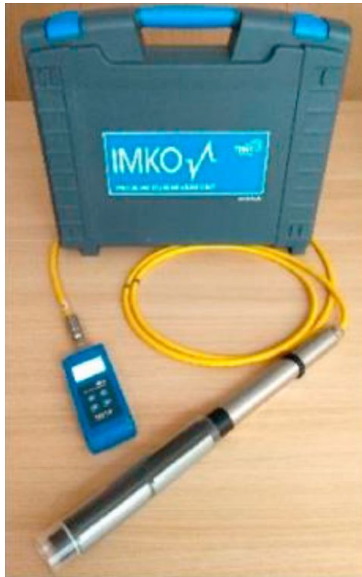
Figur 17: TDR-sensor TRIME PICO IPH T3 som ble brukt i prosjektet (Pieš, J. & Môcová, L., 2019)
