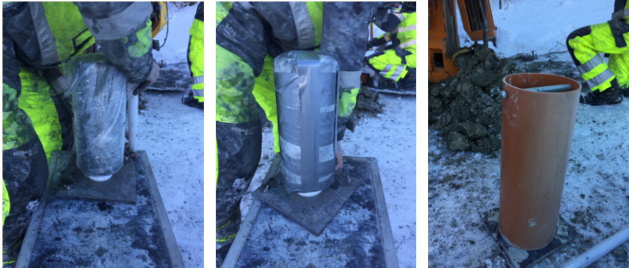
Figur 3.5: Etter prøven er tatt opp av bakken, pakkes den inn i plasfolie (t.v.) før den forsegles med teip (midt). Deretter tres en plastsylinder over den innpaktede prøven (t.h.) som skrues på bunnplaten for en sikker transport.
