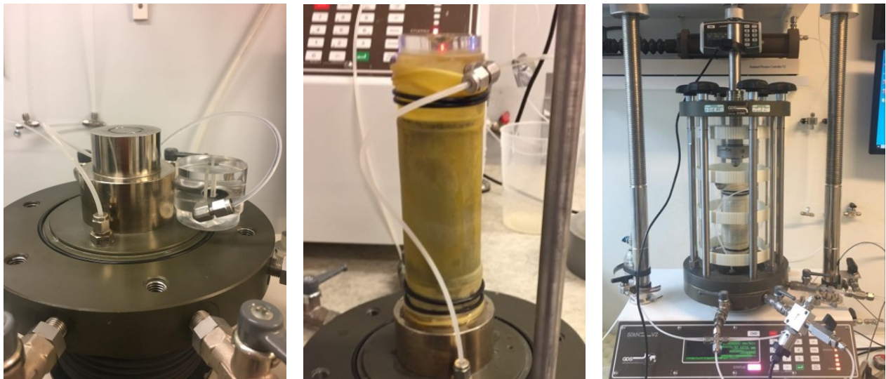
Figur 6.5: Til venstre: Pedestall, bunnstykke og toppstykke. Midten: Klar prøve med gummimembran og o-ringer. Til høyre: Klar prøve med cellebeholder.
