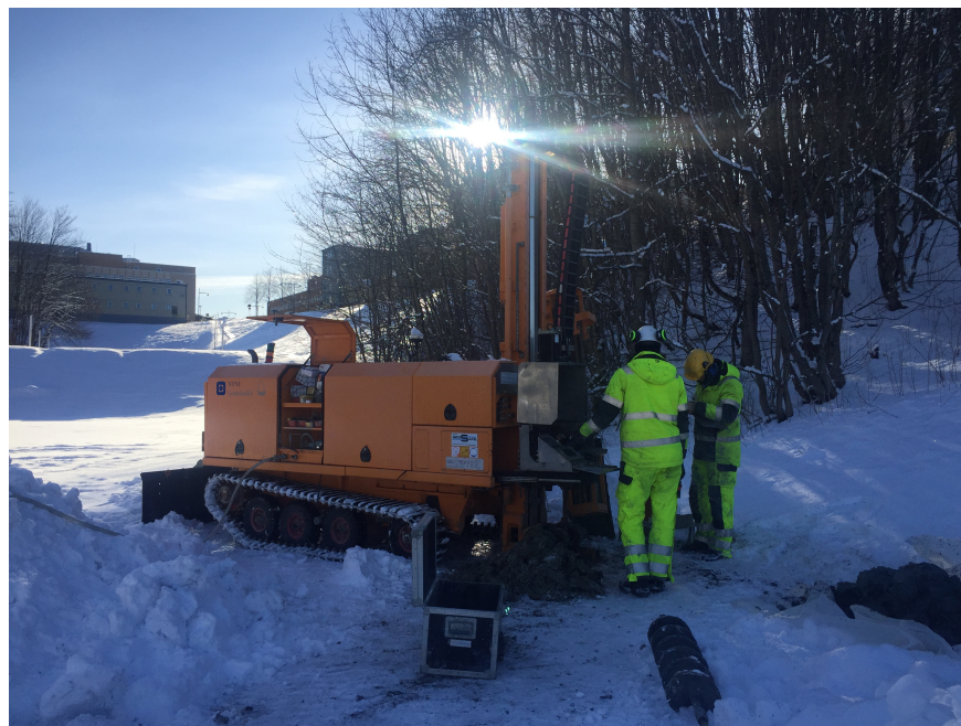
Figur 3.1: NTNUs geotekniske borerigg med boreledere Espen Andersen og Karl-Ivar Volden Kvisvik. Bildet er tatt like før blokkprøvetakingen startet.
