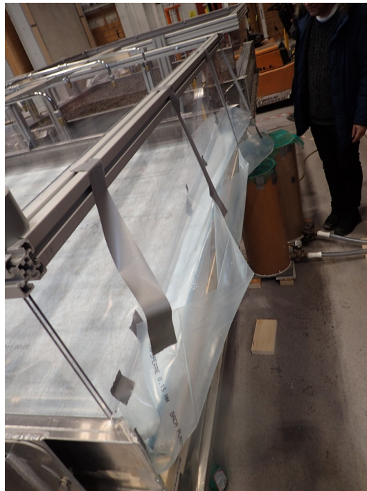
Figur 57: Ferdig takrigg for tester uten singel over isolasjon
