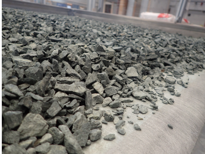
Figur 70: Bildet viser et 50 mm lag med singel over fiberduk
