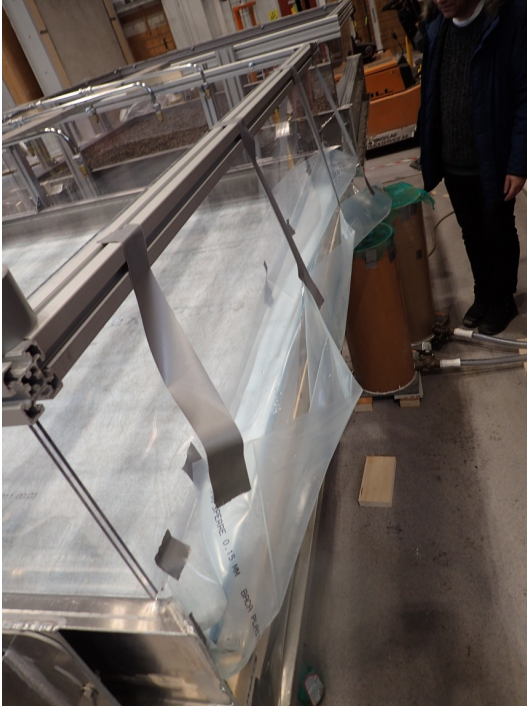
Figur 58: Oversikt over lagd takrenne av damp-sperre som skal fange opp vannet som dreneres på takoverflaten
