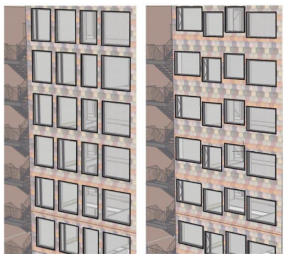
Figur 5.7: Illustrasjon av endret fasadeutforming som følge av ombruksvinduenes størrelser (Elverum, 2020).
