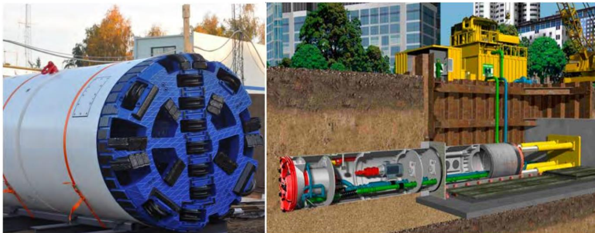
Figur 5: Venstre: Lukket rørfront (M.J, u.å) Høyre: Slam-maskin med lukket front (Myhre og Olimb, 2015).
