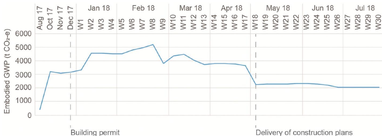
Figur 21 - Utvikling av iboende tonn CO 2 ekvivalenter gjennom designprosessen (Hollberg et al., 2020)
