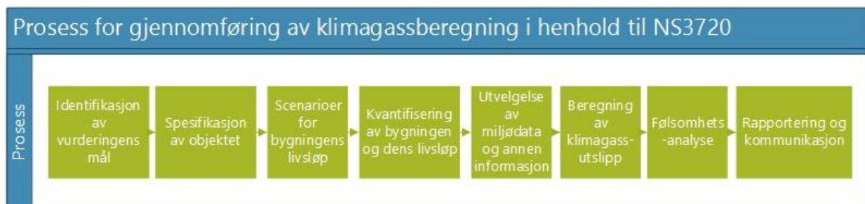
Figur 13 - Flytskjema som beskriver prosessen for klimagassberegninger (forenkling av figur 1 i NS3720)
