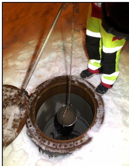
Figur 8: Innsamling av vaskevann fra tunnelvasking i Torsbuåsen tunnel
