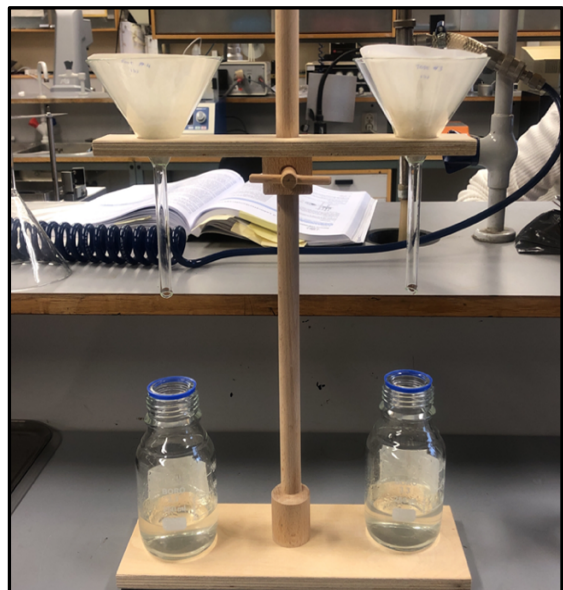
Figur 10: Filtrering av vaskevann fra tunnelrengjøringene og snøprøvene
