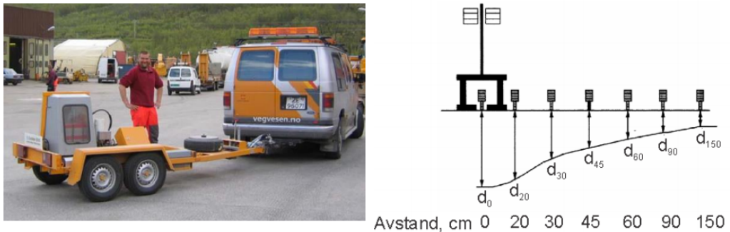
Figur 3.1: Hengermontert FWD (t.v.) og måleprinsipp (t.h.) (Statens vegvesen 2015a)
