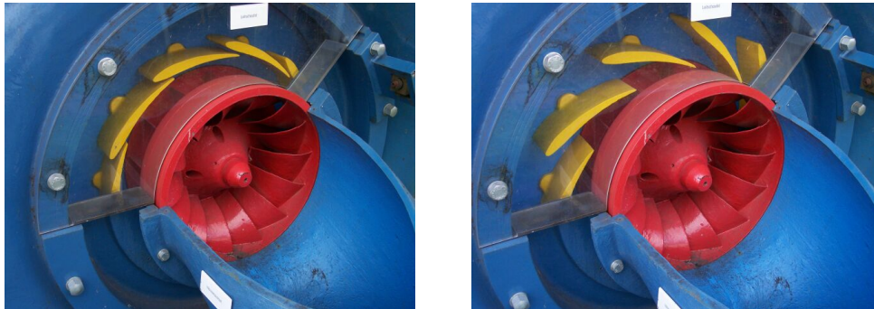
Figur 3: Turbinregulering med ledeskovler, lukket stilling til venstre og åpen stilling til høyre [99]
