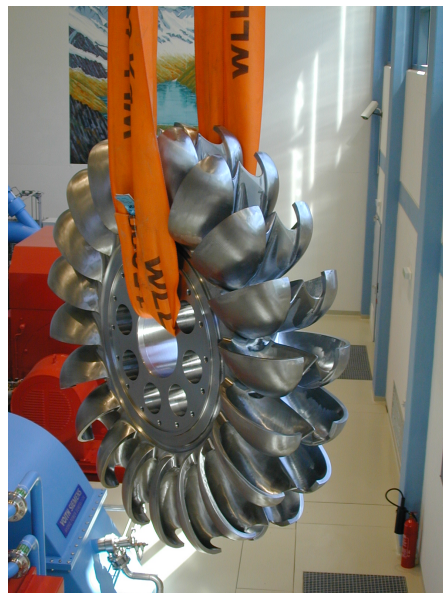
Figur 4.3 – Løpehjulet til en peltonturbin [19].
