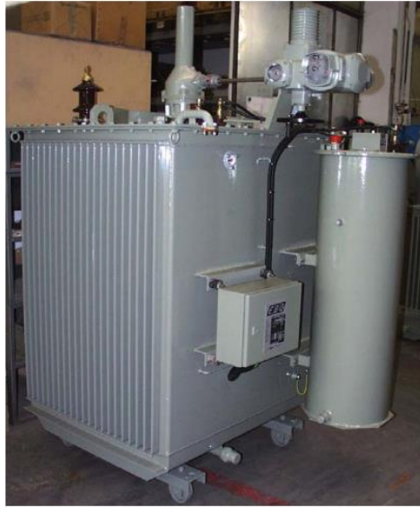
Figur 5.1 Jordslutningsspole av dykkjernetype for 22/\sqrt{3} kV, 10 - 100 A, 2 timers drift og utstyrt med parallellmotstand. Parallellmotstanden er sylindren til høyre for styreskapet.
