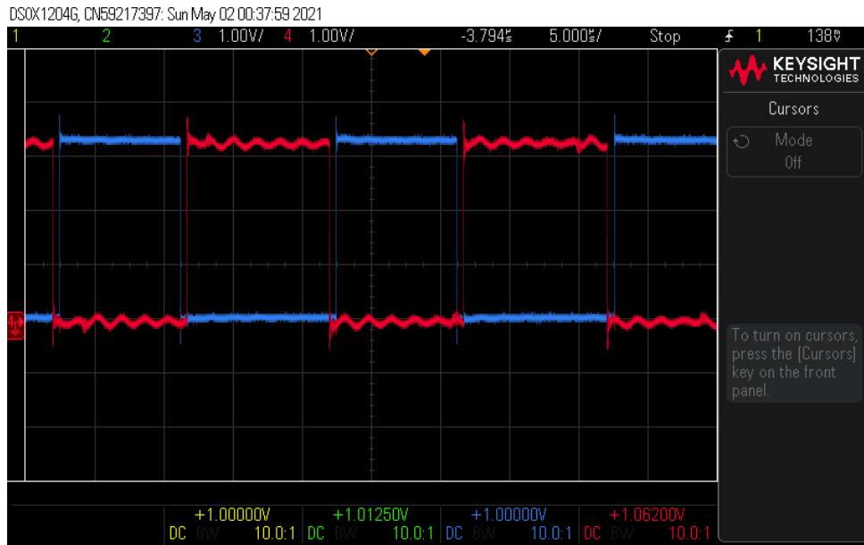
Figur 4.26: To komplementære PWM-signaler
