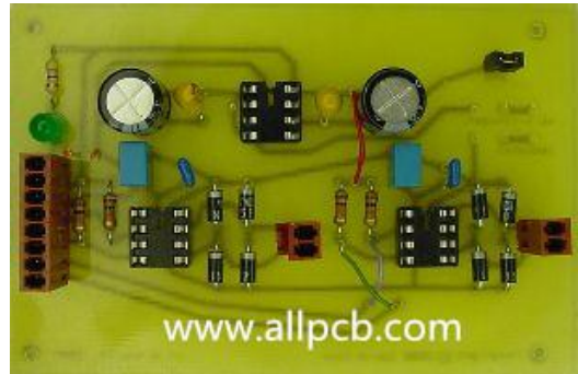
Figur 2.2 Ensidig kretskort med komponenter på en side og baner på andre side [1]
