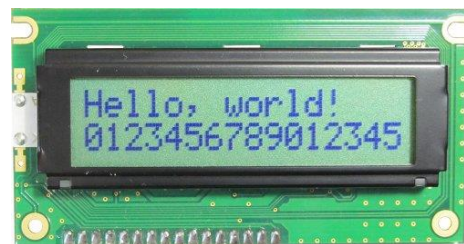
Figur 2.11 En enkel LCD som kan vise 2x16 symboler om gangen [64]
