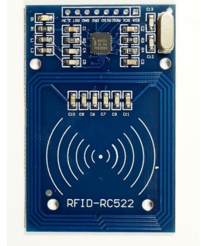
Figur 2.19 MFRC522 RFID modul
