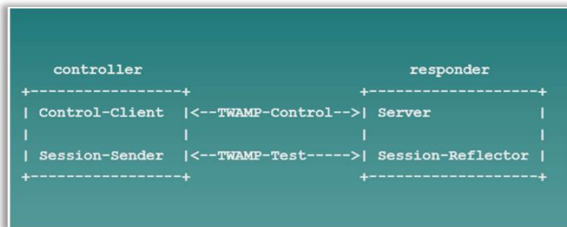
Figur 2. 18: Generelt oppsett av TWAMP-protokollen. [14]
