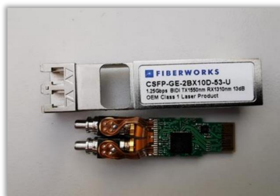
Figur 2. 19: figuren viser hvordan en SFP ser ut innvendig.
