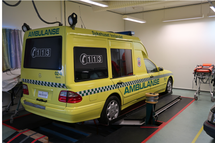
Ambulansen står på en styringsplate som er ankret foran. Den beveger seg vha. to sylindere lenger bak. (kreditering: Isac Kallevig)
