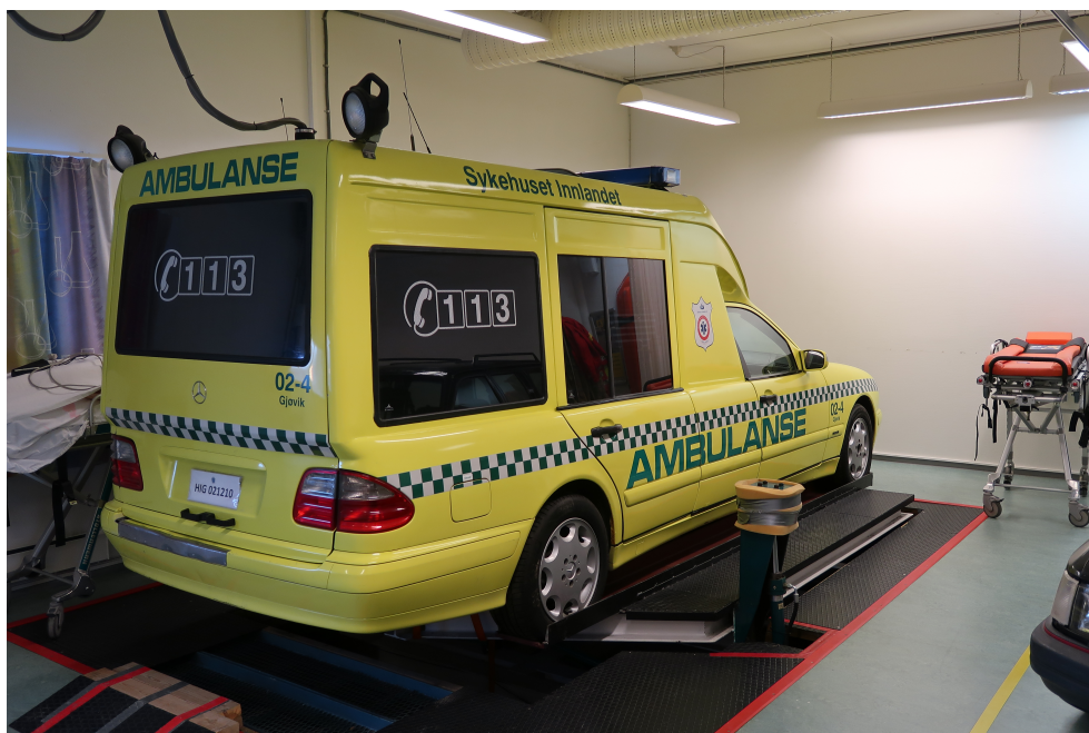
Figur 1.1: Ambulansen står på en styringsplate som er ankret foran. Den beveger seg vha. to sylindere lenger bak. (kreditering: Isac Kallevig)
