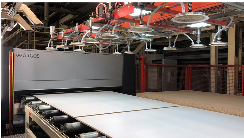
Figur 2: Skanner med tilhørende sortering ved hjelp av sugekopper [3].
