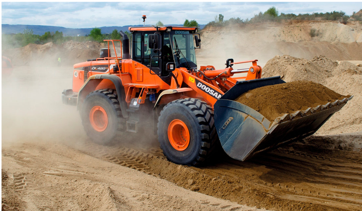
Figur 2.9: Viser 23 tonns pukkverk-hjullaster. DL420 CVT. (anleggsmaskinen.no).
