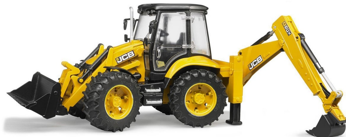
Figur 2.11: Viser Gravelaster JCB-5CX.(anleggsmaskin.no).
