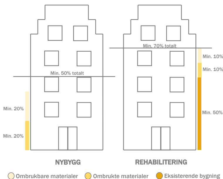
Figur 2-4: FutureBuilt sin definisjon av sirkulære bygg.
