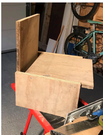
Viser avstanden mellom klaffen og skrivebordsplaten i passiv tilstand som oppstår som følge av lengre momentarm.
