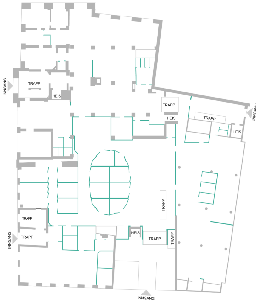
Tegning viser vegger i etasje 1. Plassering av antatt flyttbare innervegger vises i grønt.
