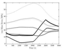
(d) von Mises stress in the rotor along six equidistant radii.
