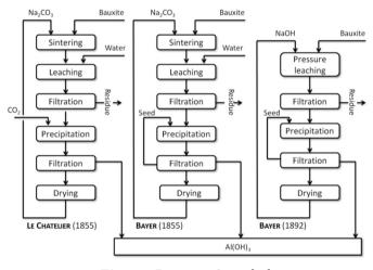
Fig. 21. Bauxite refining [33].
