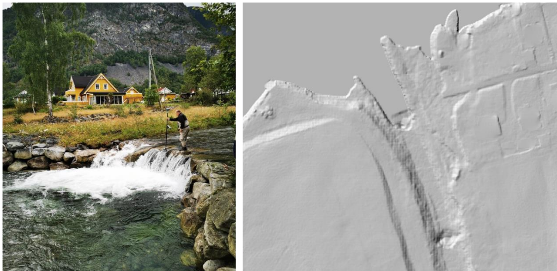
Figur 9 Venstre: Terskel 1. Høyre: Terrengmodell fra Høydedata kombinert med GPS-punkter fra feltarbeid.
