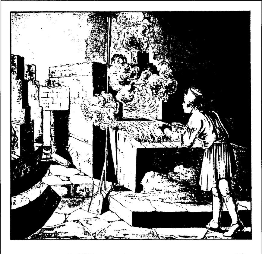
Abb.6: Flammofen zum Trocknen und Abrösten (Bild 4)
