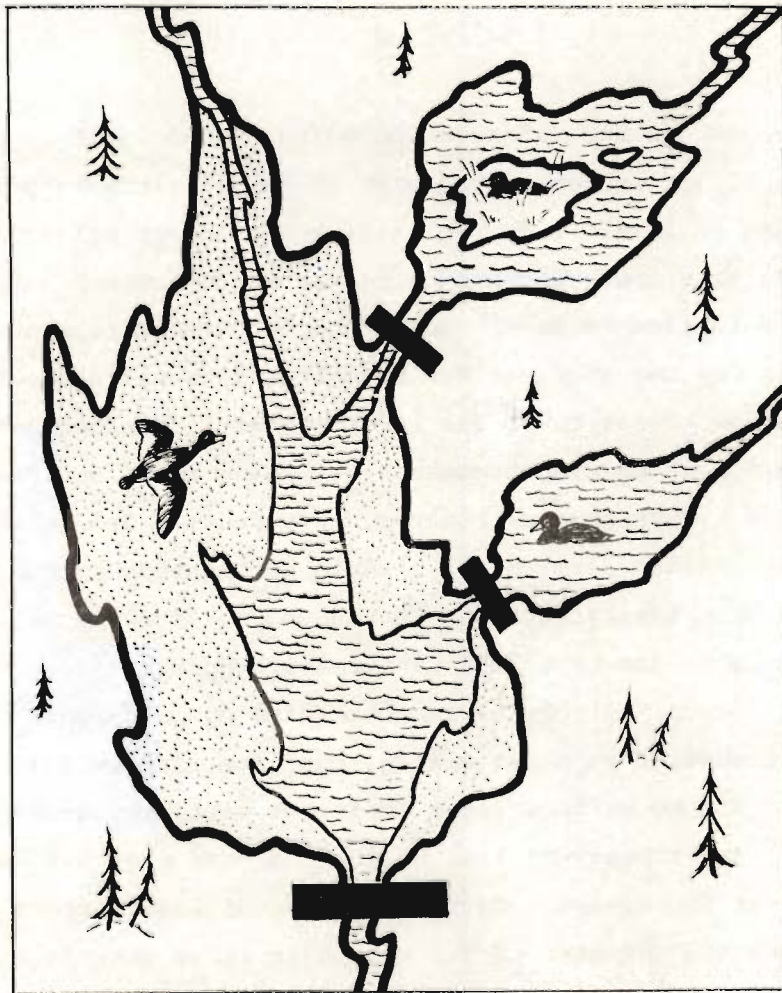
Fig. 38. Sekundær-dammer ved nedtappet magasin. Ender ruger gjerne på små øyer. Etter Munthe-Kaas Lund (1961).
