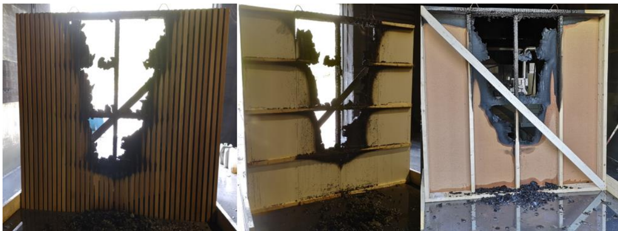
Figur 5.19: Skadet areal på fremside, bak spilepanelet og bakside av substrat etter test 4
