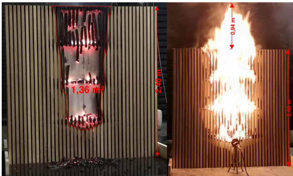
Figur 5.6: Kalibrering, arealberegning og måling av flammehøyde
