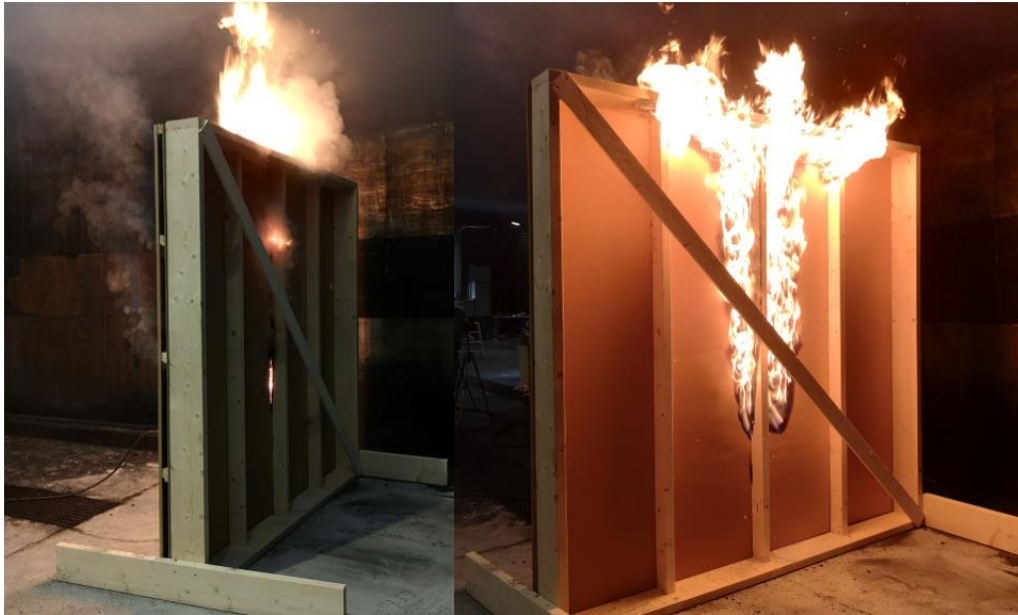
Figur 5.18: Baksiden av prøveelementet etter 9 minutter (venstre) og 14 minutter (høyre)
