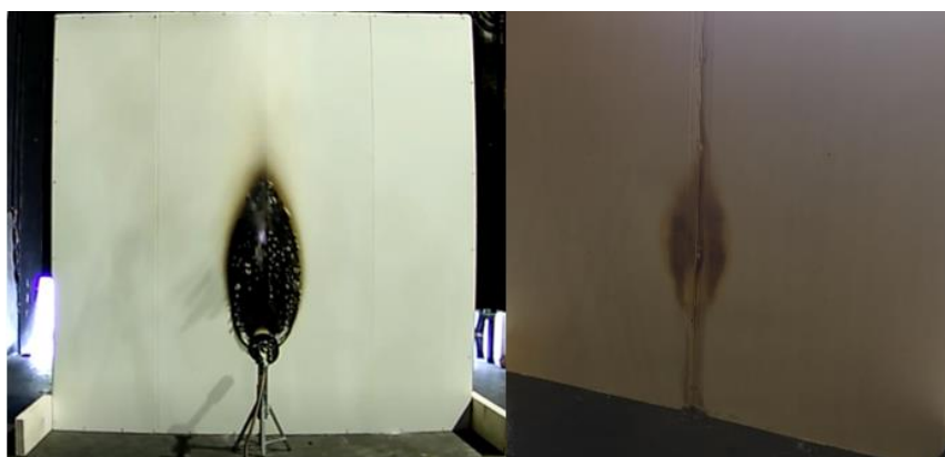
Figur 5.9: Skadet areal etter referansetest
