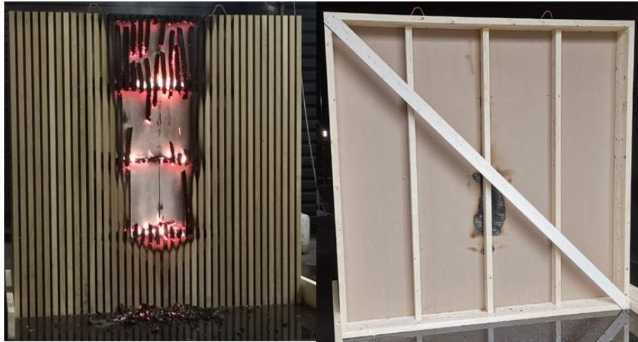
Figur 5.15: Skadet areal etter test 3
