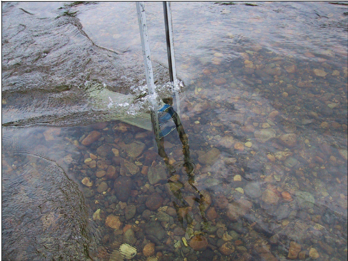
Bilde 4. Fellestativ for drivprøver med to påmonterte håvposer. Foto: Jarl Koksvik©
