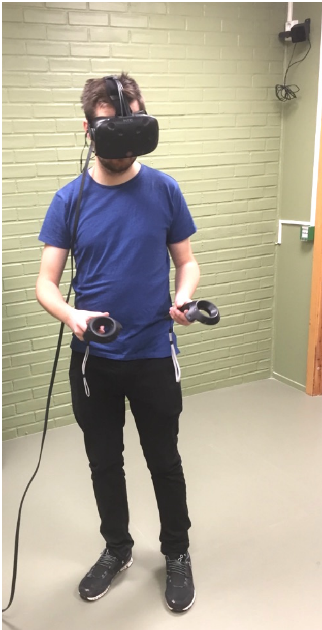
Figur 7 HTC Vive i bruk med VR-briller, håndkontrollere og en av basestasjonene på veggen oppe til høyre i bildet. Personen på bildet er meg. Foto: Berit Bungum.
