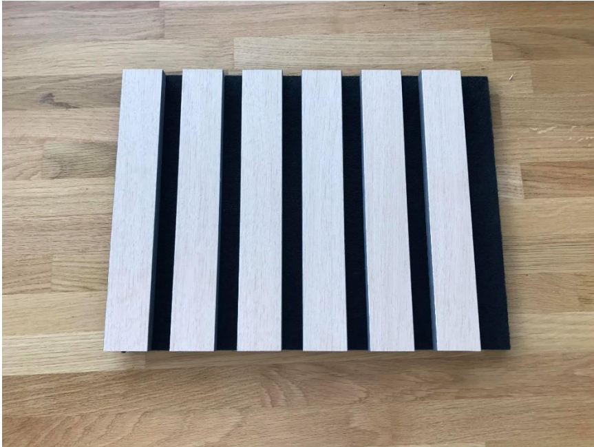
Figur 13: Vareprøve av spilepanel med sort bakplate og spiler av eikfinert MDF
