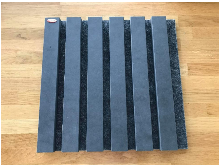
Figur 12: Vareprøve av spilepanel med koksgrå bakplate og spiler av gjennomfarget MDF
