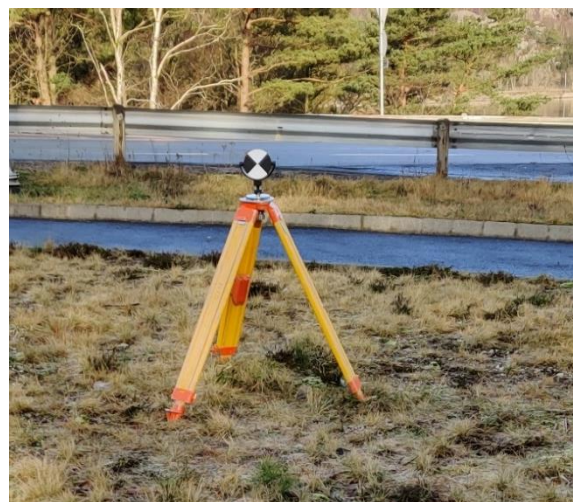
Figur 4 Target brukt til å georeferere punktskyer
