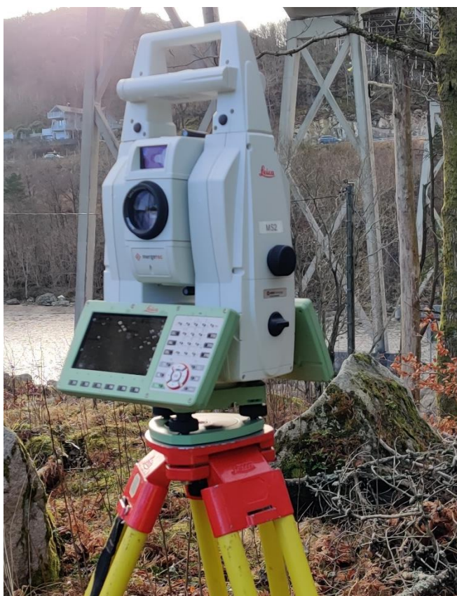
Figur 8 Leica Foto: privat. MS60. Totalstasjonen brukt ved Eigerøy bru
