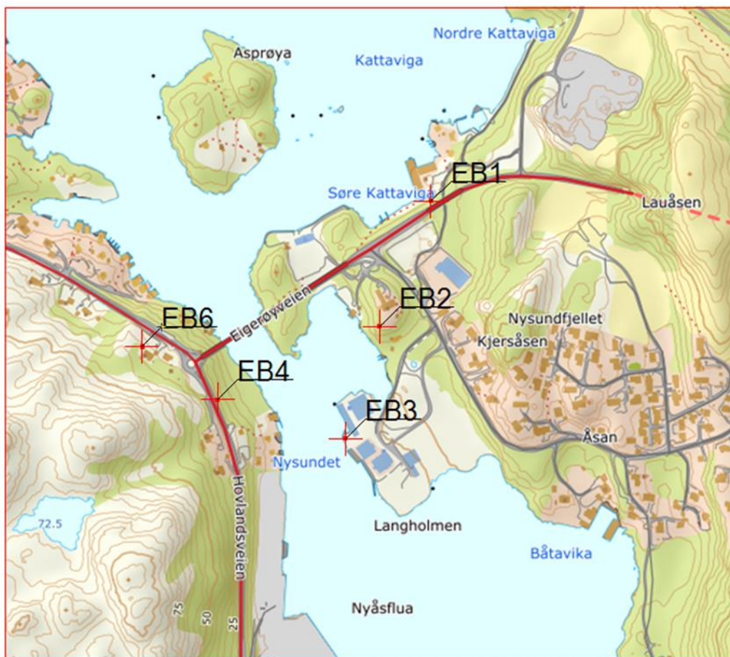
Figur 6 Oversikt over fastmerker ved Eigerøy bru
