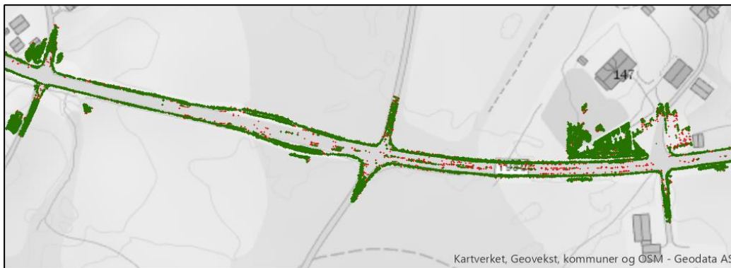
Figur 30: Resultat ved å sile 0.5, 0.001, 10 med parameterkombinasjonen 0.25, 1, 6. Grønne punkter visualiserer lav vegetasjon, og røde punkter viser støy.
