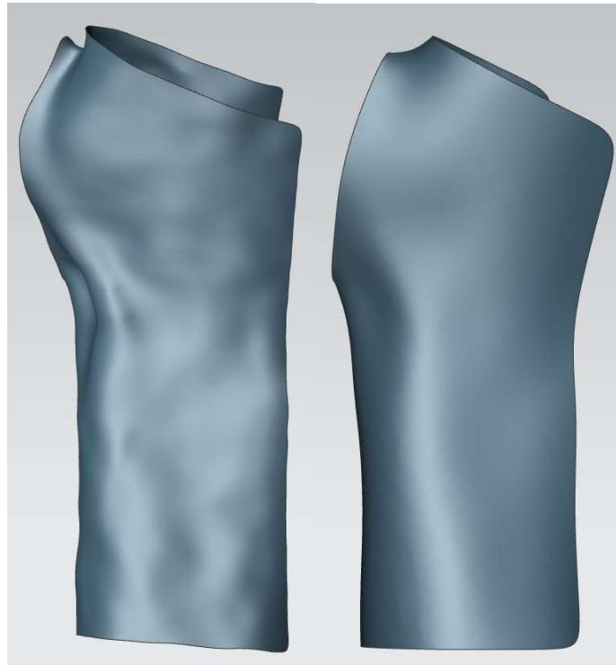
Figur 57 - Før og etter bruk av funksjonen "Adjust minimum radius" (Egne bilder)
