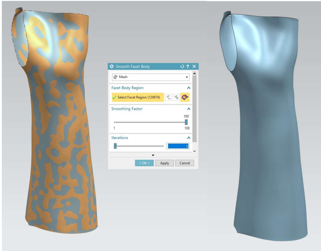
Figur 55 - Skann ved bruk av funksjonen "Smooth" (Egne bilder)
