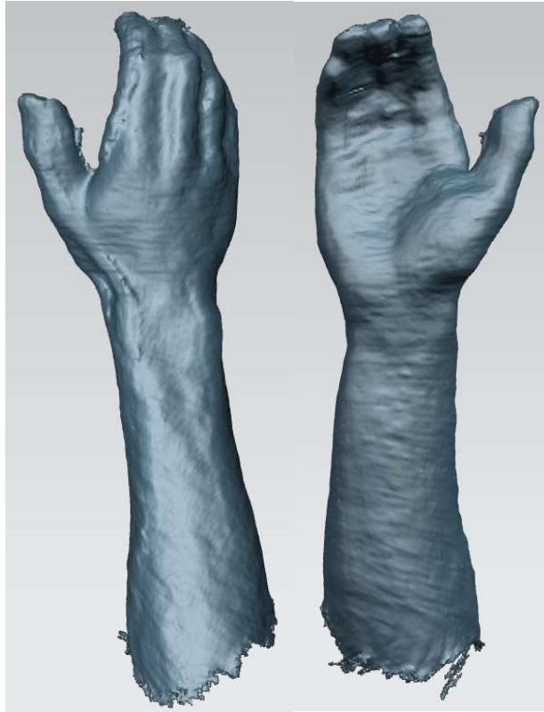
Figur 77 - Rå skann med manuell skanner og iPhone
