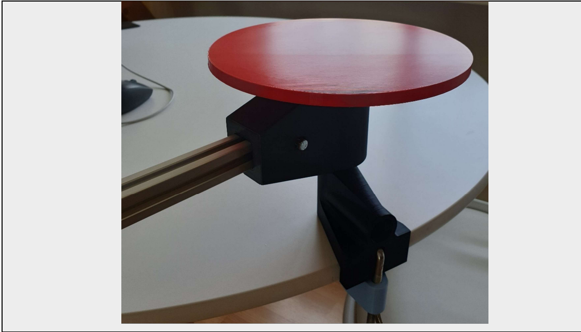
Figur 67 - Montering av bordskanner (Egne bilder)
