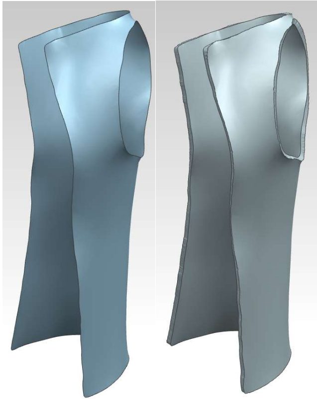
Figur 59 - Før og etter bruk av funksjonen "thicken" (Enge bilder)
