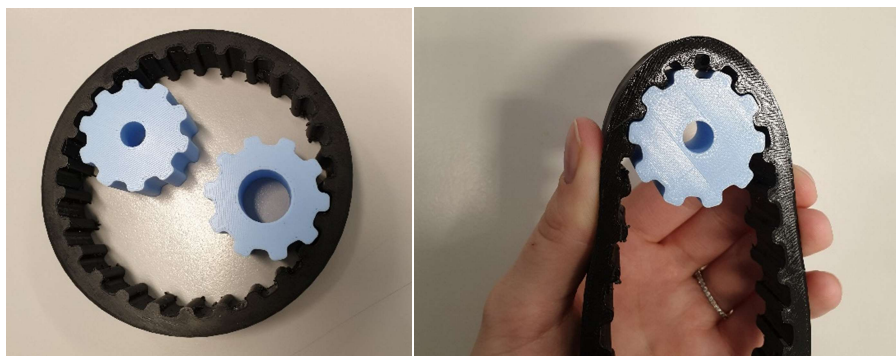
Figur 73 - 3D-printet reimdrift (Egne bilder)
