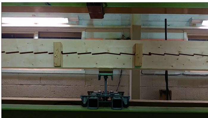
Figur 17 Tannbjelke under produksjon. Bilde: Rennebu-Bjelken AS.
