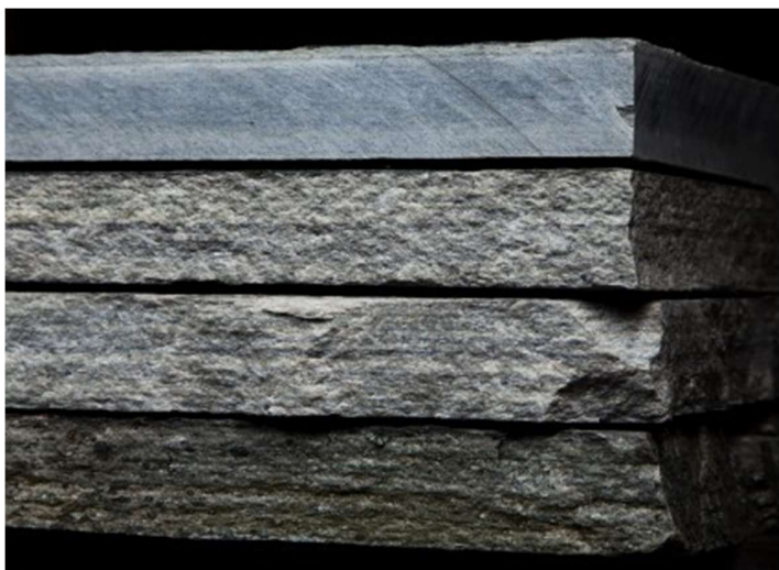
Figur 58 Kanten av Oppdalsskifer ved ulike kappemetoder. (52)
