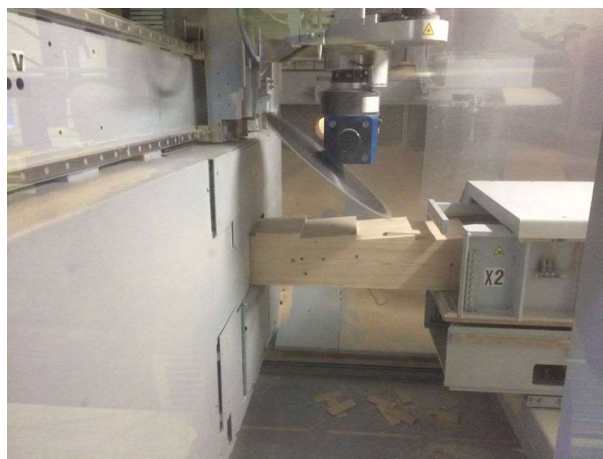
Figur 20 Lukket maskinrom med bånd som fører treverket inn og ut av sagrommet. Bilde: Rennebu-Bjelken AS.
