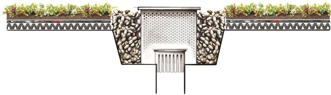
Figur 6 Oppbygningen av det grønne taket (Vatnaland, 2020)
