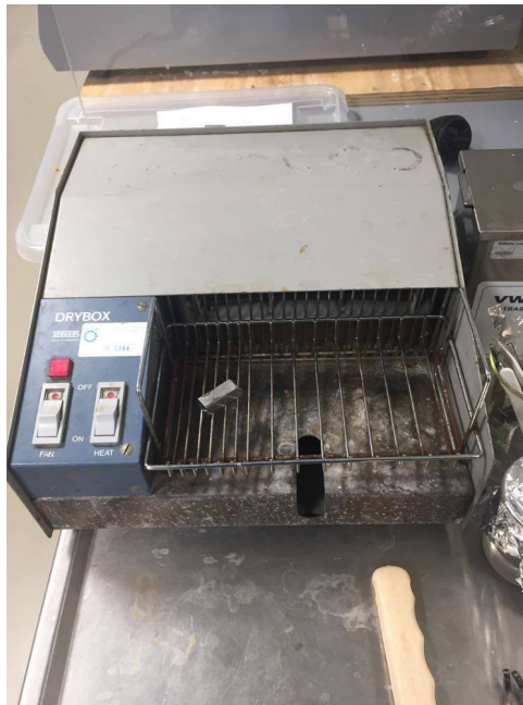
Figur 3.8: Drybox fra Struers. Brukt for å tørke prøver etter rensing i ultralydbad.
