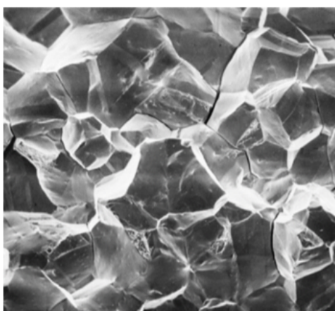
Figur 2.7: Elektronmikroskopbilde av bruddoverflaten til et intergranulært brudd [3]
