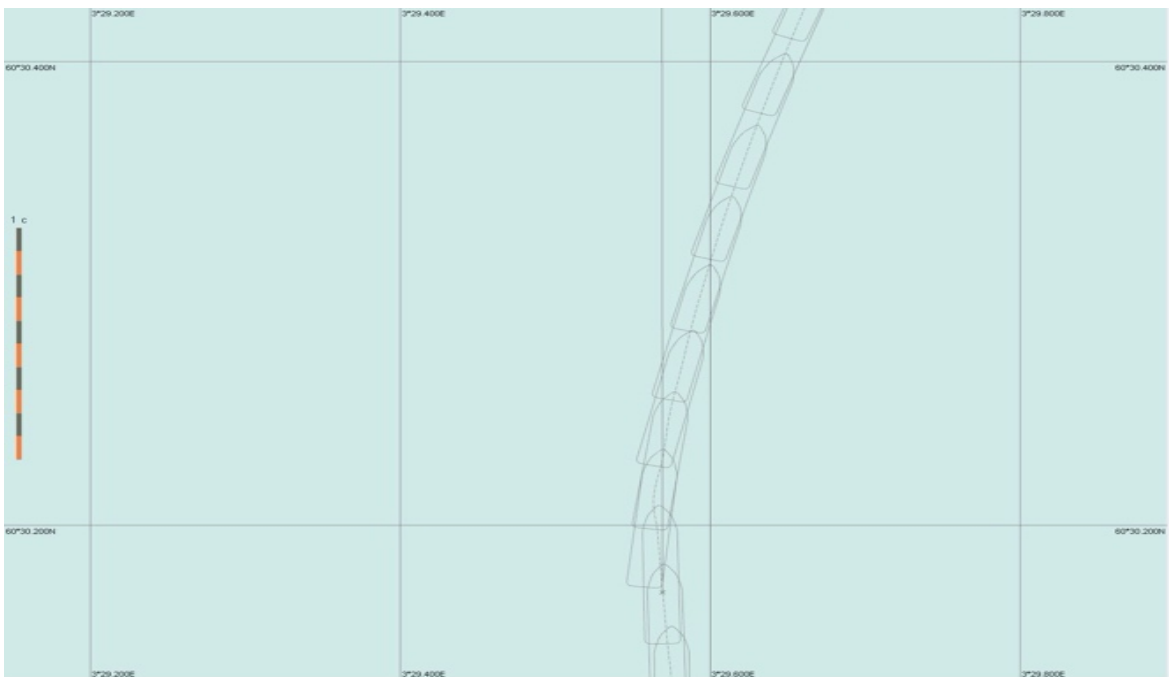
Figur 32: Observasjon av sideveis forflytning på hekken når vaieren traff styrbord styrepinne. (Skjermdump simulator).
