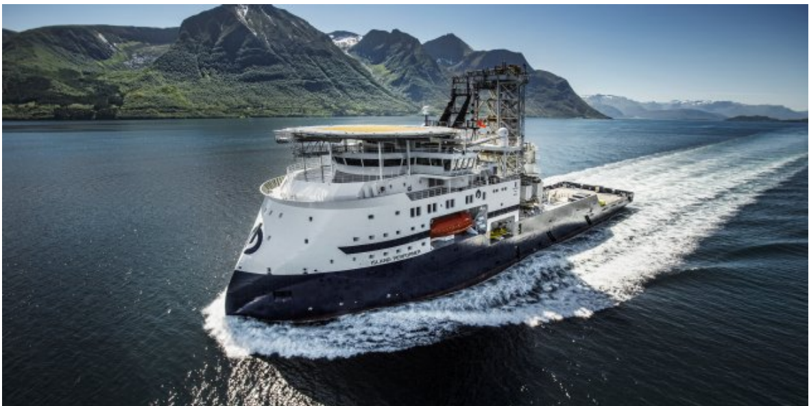
Figur 12: Illustrasjon av Ulstein Group sin "X-Bow" på fartøyet Island Intervention. Kilde: (Ulstein Group).
