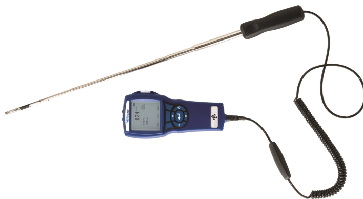
Figur A2.5: TSI VELOCICALC 9565 med 964 sonde
