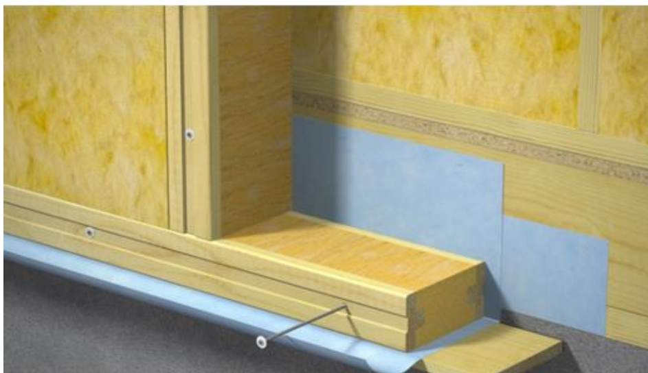
Figur 34: Montering av GPS på bindingsverk vegg (66).
