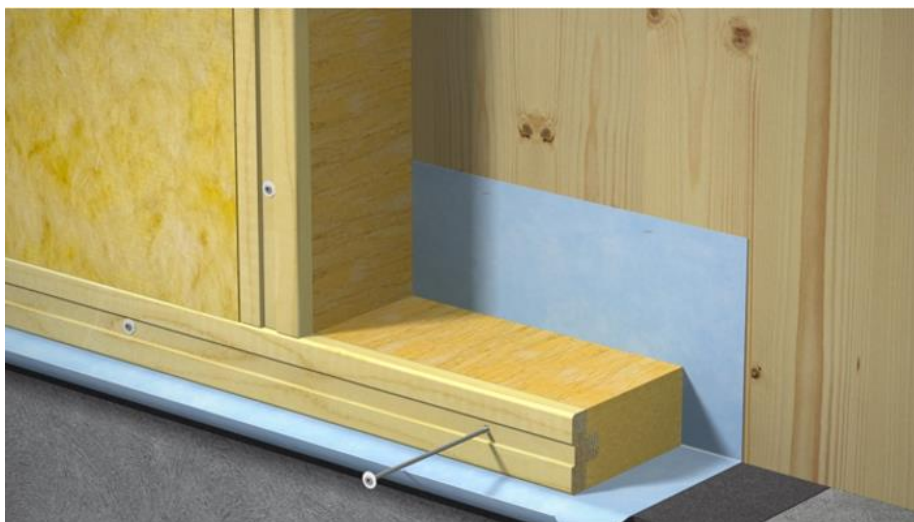
Figur 35: Montering av GPS-system på massivtrevegg (66).
