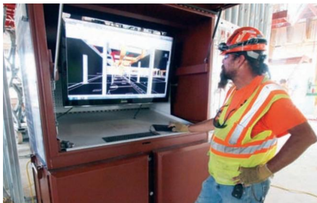
Bilde 1 MERS i bruk på byggeplass. (Skanska, 2012)
