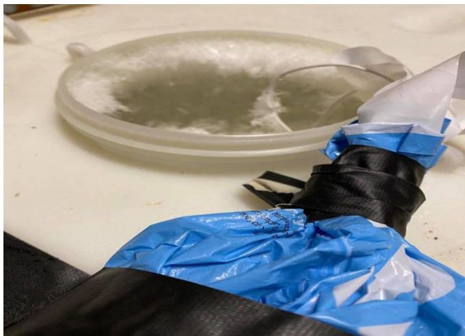
FIGUR 17: OVERFLATEN AV ISBLOKKEN ER ETTER INSPEKSJON HELT FROSSET
