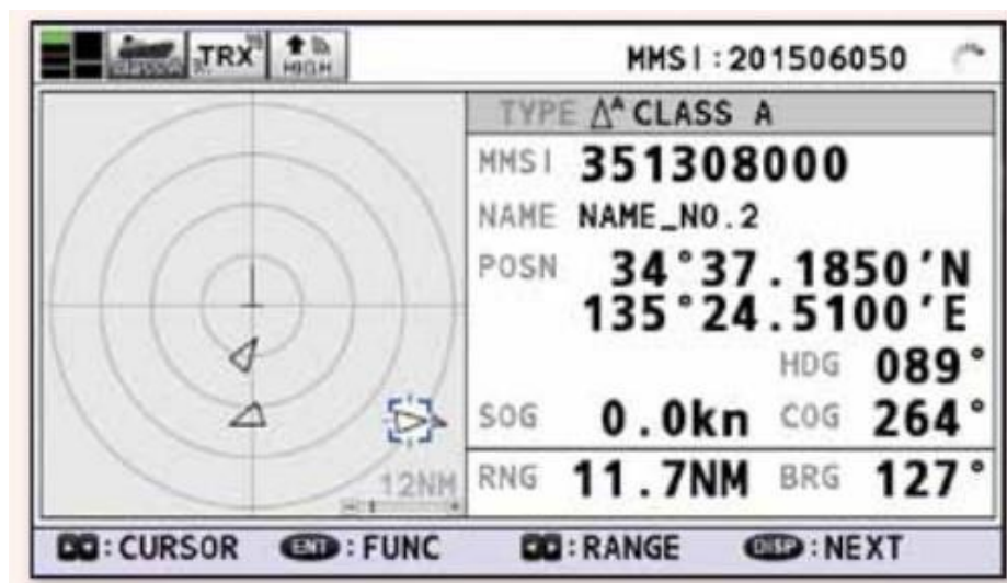
Figur 2-19 Brukergrensesnitt på Furuno FA-170 Kilde: Furuno Electric Co. Ltd.
