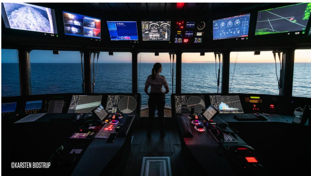
Figur 2-25 Unified Bridge på Hurtigruteskipet Roald Amundsen Foto: Karsten Bidstrup
