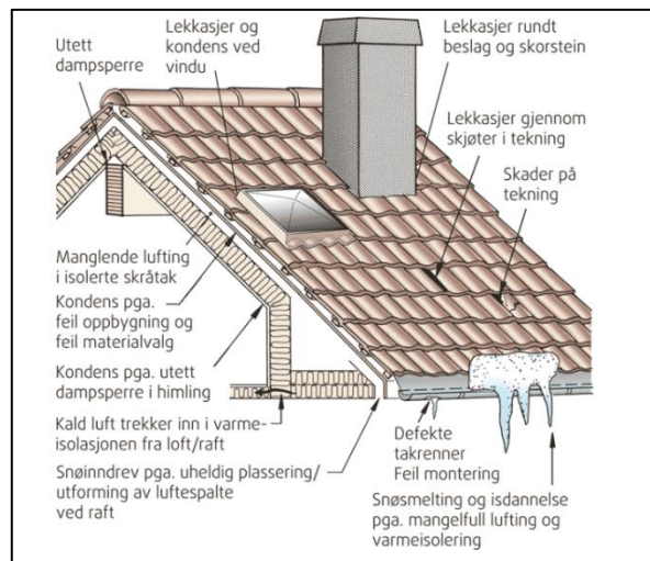
Figur 14: Vanlige skader og feil i isolerte skråtak og tak med kaldt loft (Skjermdump, Byggforsk, 700.110, 2010)
